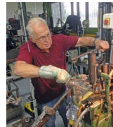
De haut en bas : Rainer Gerstenberg en pleine action lors de la réparation et l'ajustement de la vieille fondeuse.
